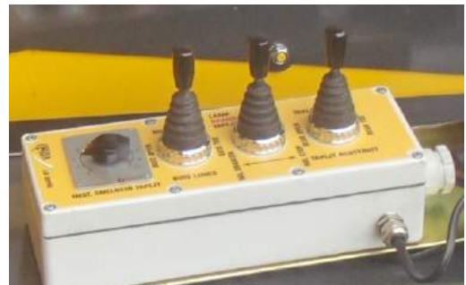
Joystickkasten Bedienung mit Potentiometer
