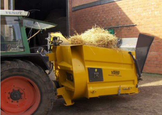
Dreipunkt Anhang für Schlepper ab 100 PS
