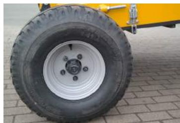
Achse Angeschraubt Räder 10.0/80-12
