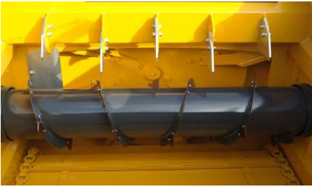
Standard Auflösewalze 18 Schneidmesser
