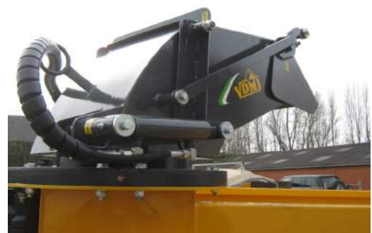
3-Fach Auswurfrohr / Höhe - 28 cm
