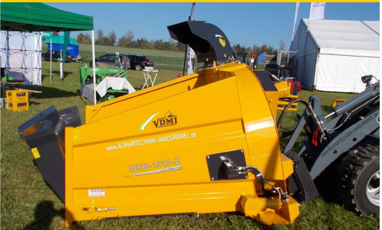
Bilder WSB 1513Z : Oben standard Ladeklappe mit Ketten / Unten mit hydraulischer Ladeklappe Ballenlänge bis 2 Meter
