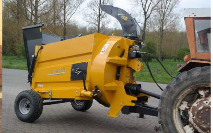
Gezogene Einstreumaschine für Schlepper ab 50 PS
