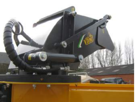
3- Fach Auswurfrohr / Höhe - 28 cm
